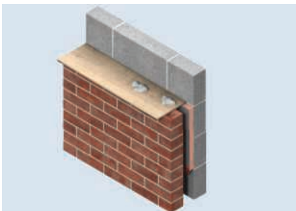
Gebruik bijvoorbeeld een afdekplaat om de spouw en de bovenkant van de spouwisolatie te beschermen.
