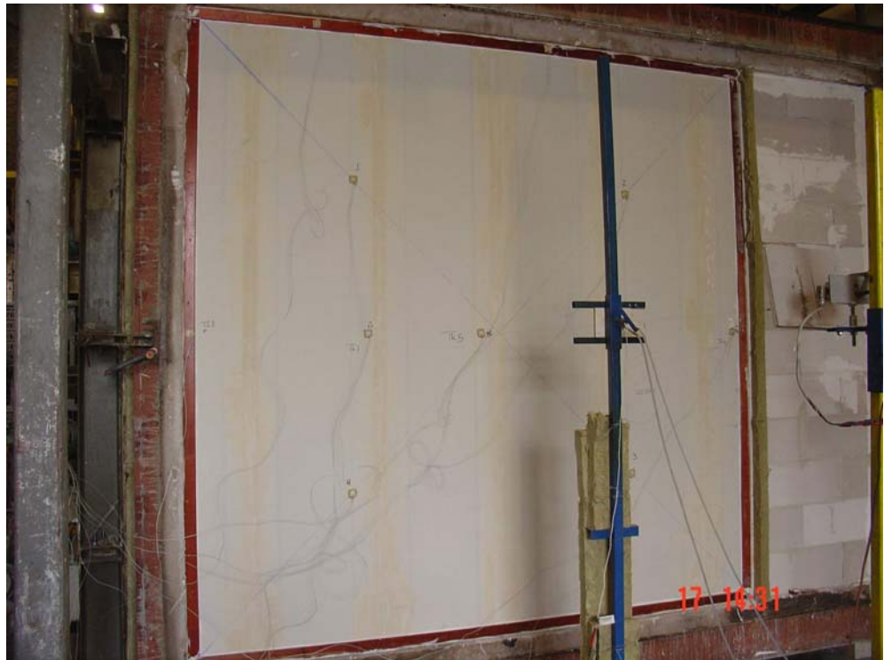
Figuur C 1: Proefstuk voor aanvang van de brandproef
