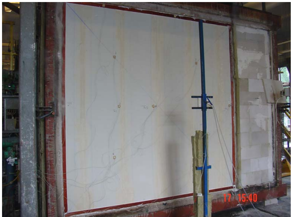
Figuur C 2: Proefstuk na 61 minuten verhitting
