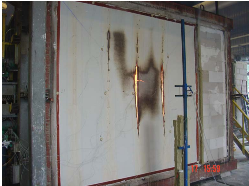
Figuur C 3: Proefstuk na de brandproef
